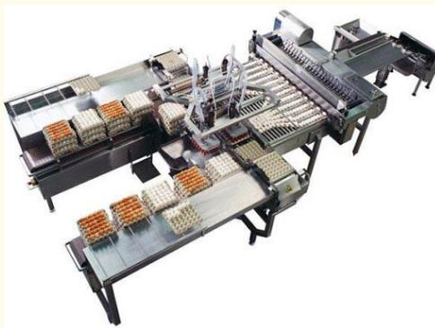
*Figure 27 – Œufs pesés et emballés par une machine (Ovobel, n.d.)*
