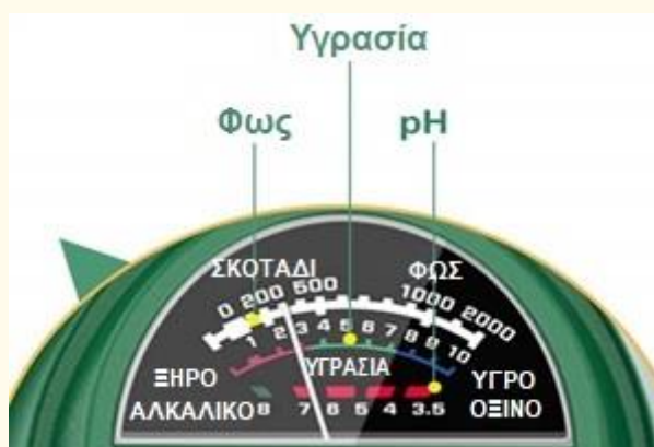
Σχήμα 2. Οθόνη αισθητήρα υγρασίας - που εμφανίζονται τα δεδομένα (Upgrade 3-in-1 Soil Moisture Meter,χ.η.)
