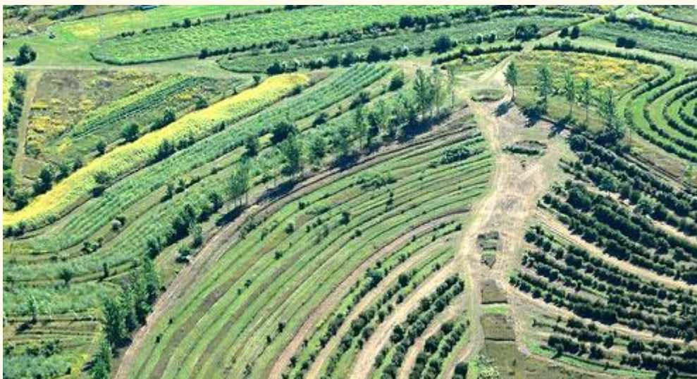
Σχήμα 13 - Η επιφανειακή κατεργασία του εδάφους με βάση το σύστημα Keyline λαμβάνει χώρα κάθε χρόνο στο πλαίσιο ενός συστήματος διαχείρισης νερού (Crkeyline, χ.η.)
