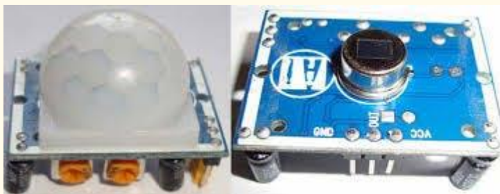
Σχήμα 1 Αισθητήρας PIR, πηγή: https://create.arduino.cc/projecthub/biharilifehacker/arduino-with-pir-motion-sensor-fd540a
