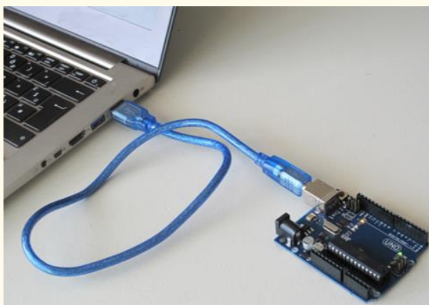
Σχήμα 2 Συνδέστε το Arduino στη θύρα USB του υπολογιστή σας. Πηγή: www.getready.io/arduino
